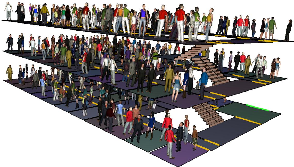
Bild 18: Test 8, Darstellung des Pathfinder-Modells mit 448 Personen zum Startzeitpunkt ( $t = 0$  s)
